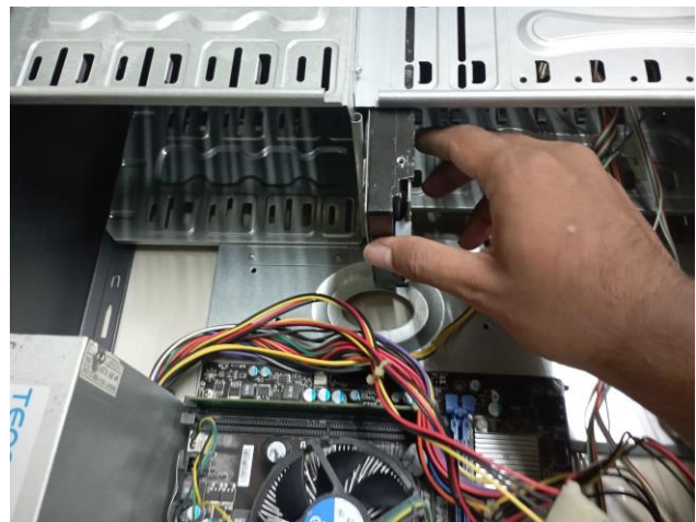
Pasang harddisk pada slot hardisk dan pasang skru
