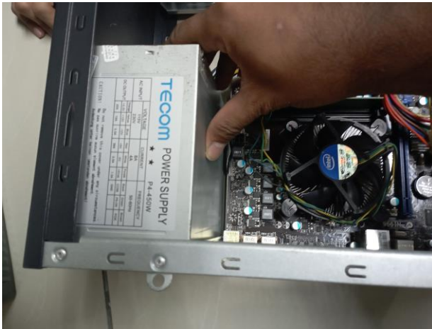
Masukkan Power Supply kedalam casing dan pasang skru
