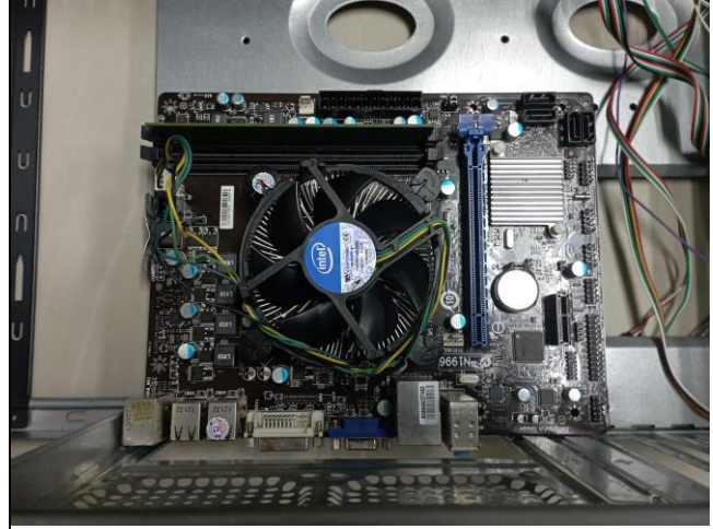
Pastikan kedudukan motherboard sesuai dengan casing dan pasang motherboard pada casing
